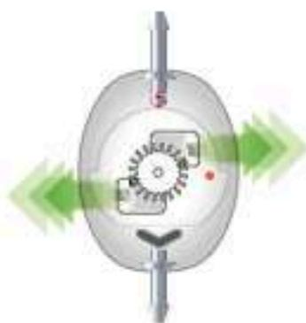
Com design exclusivo, o rotor da válvula Sphera Pro possui duas travas mecânicas de segurança que se deslocam em sentidos opostos, podendo travar duplamente ou individualmente o sistema contra desprogramação não intencional.
