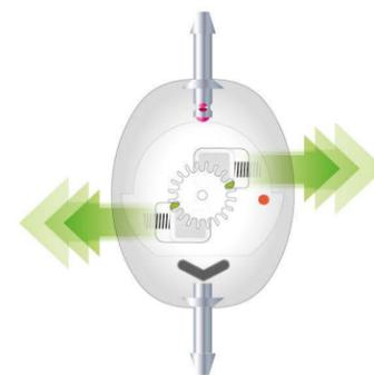
Com design exclusivo, o rotor da válvula Sphera Pro possui duas travas mecânicas de segurança que se deslocam em sentidos opostos, podendo travar duplamente ou individualmente o sistema contra desprogramação não intencional.
